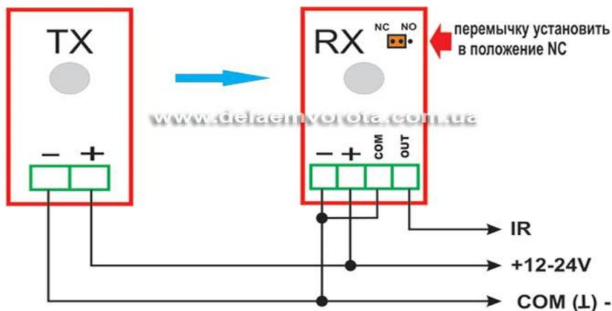
Если на фотоэлементе RX имеется селектор NC/NO, то установить джампер в положение NC. Или проконтролировать этот момент, если джампер уже стоит в этом положении с завода.
