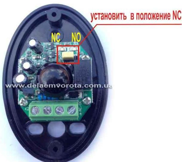
Клемма NO, если она есть, не используется. Проверяем корректность работы фотоэлементов – при закрывании ворот пересечение луча должно привести к остановке ворот и последующему их открытию.
