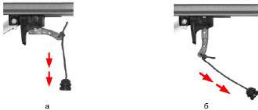
*Рис. 3. Ручная разблокировка каретки*
